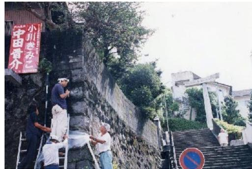
図2 坂本町、下田様方の石垣の試料採取
